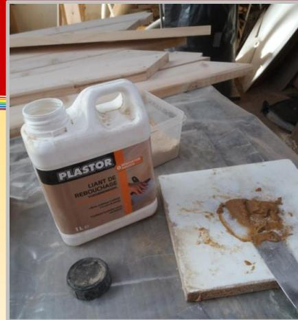
Préparation du mastic avec de la résine et de la poudre de ponçage.
