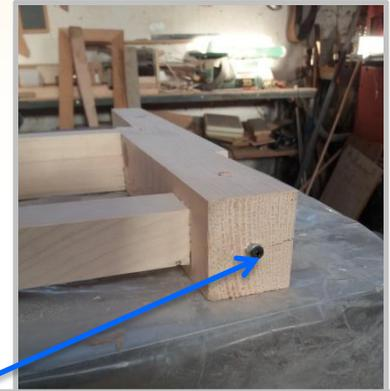
Ici, on fixe un petit écrou pour que le pied ne plaque pas au sol et qu'il puisse sécher si il se mouille.
