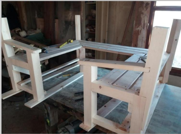
Assembler les pieds n° 1 et n° 2 avec les trois planches d'assise, côté gauche... puis préparer des barres stabilisatrices qui vont éviter que le banc se déforme.
