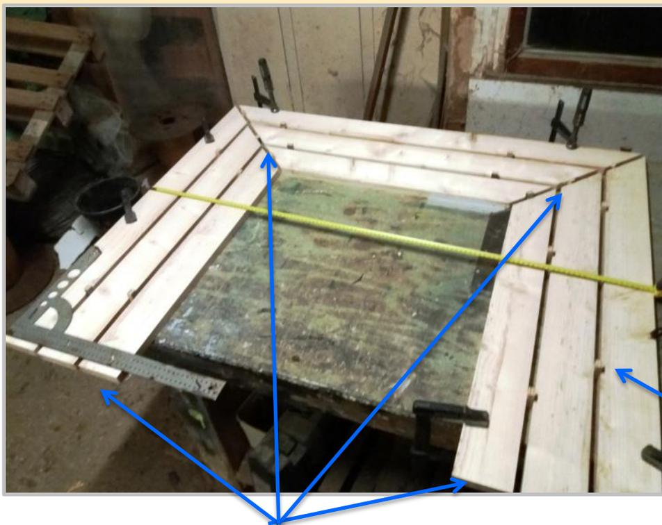
On positionne toutes les planches de l'assise sur la table d'assemblage. Ça donne une première idée du banc, il ne faut pas oublier de placer les entretoises pour maintenir un espacement régulier entre les planches.
