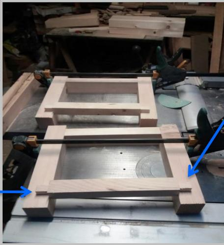
Quand un tenon doit s'enfiler en milieu d'un chevron on ne peut pas faire la mortaise avec la scie circulaire, il faut utiliser la mortaiseuse.
